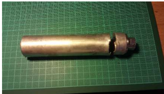
Figura 2: Motor de Combustible Sólido Destruído
