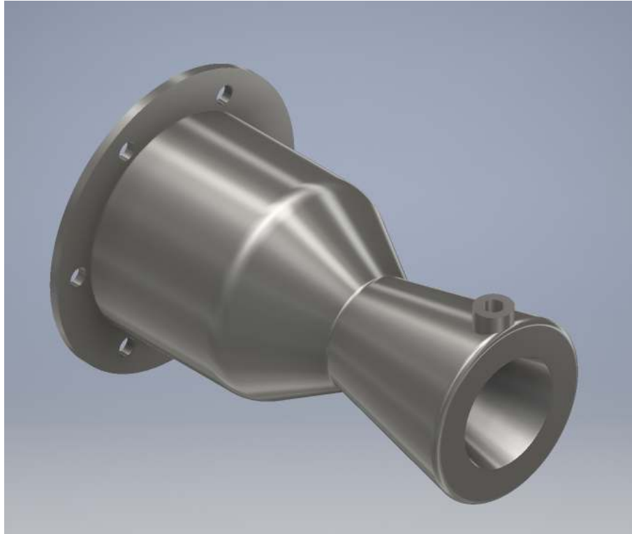
Ilustración 3.5: Concepto de motor (Versión 3). Fuente: trabajo propio.
